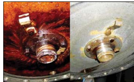
Крышка баллона грязная чистая
